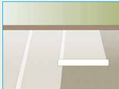
Poser le géotextile bord à bord permettant la stabilisation de la couche support.
